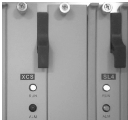
图 5.45 线路板 SL4 无输入信号时的告警显示
