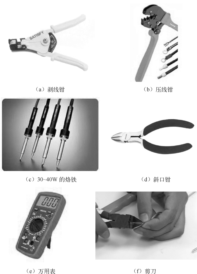
图 3.4 2M 同轴电缆接头制作常用工具
