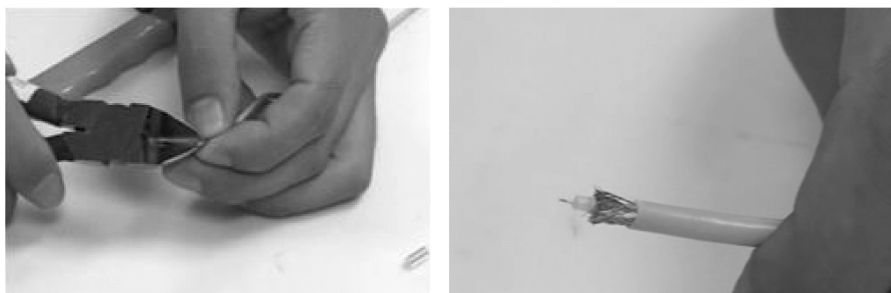
图 3.10 撕去保护胶皮，用斜口钳剪去金属屏蔽网线和乳白色透明绝缘层
