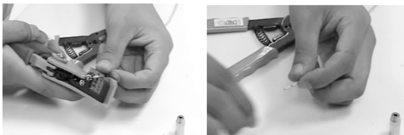
图 3.8 剥线钳剥去外皮
