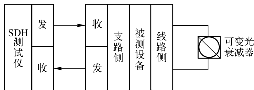
图 4.9 PDH 输入抖动容限测试框图
