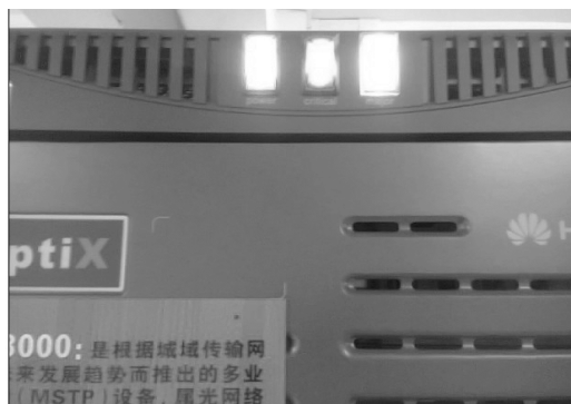
图 5.48 Opti×Metro 3000 设备发生危急告警时, 机柜指示灯显示
