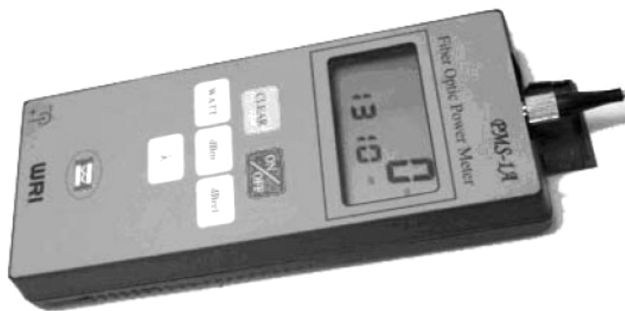
图 4.12 PMS-1A 型光功率计
