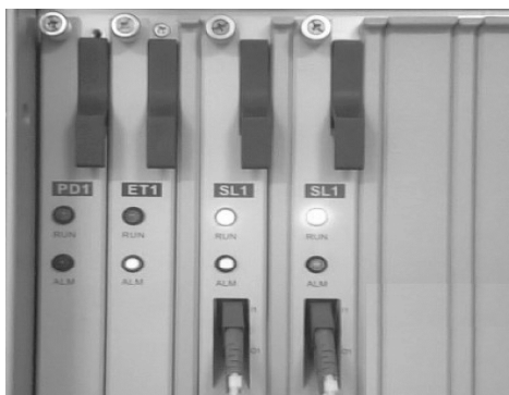
图 5.44 线路板 SL1 无输入信号时的告警显示
