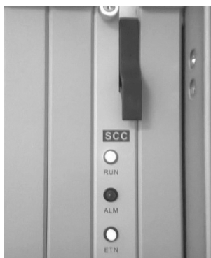
图 5.46 网管计算机未连接或未连接好时系统控制板 SCC 的告警显示
