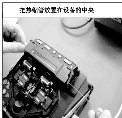
图 3.55 准备加固熔接点
