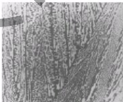
图 3-12 共晶白口铸铁的显微组织
