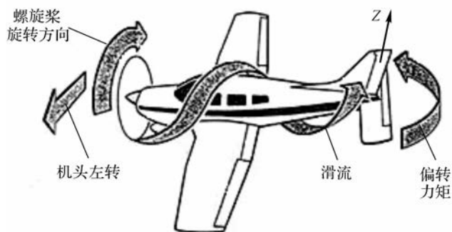
图 7-25 滑流扭转对飞机的影响
