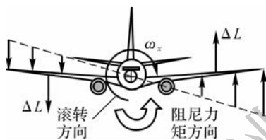
图 3-23 横向阻尼力的产生
