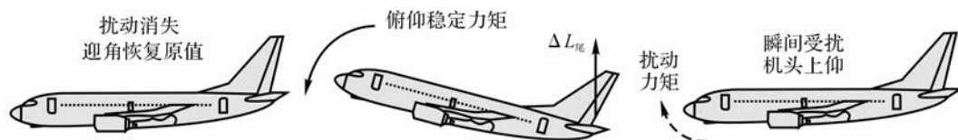
图 3-13 水平尾翼产生的俯仰稳定力矩
