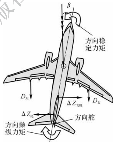
图3-36 飞机的方向操纵
