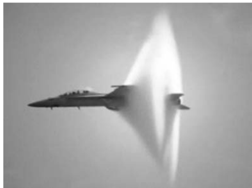
图 6-9 飞机突破声障现象
