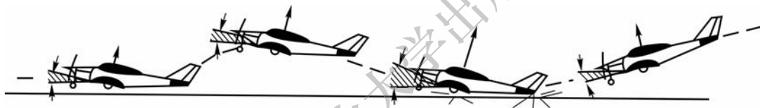
图 4-54 重接地引起跳跃
