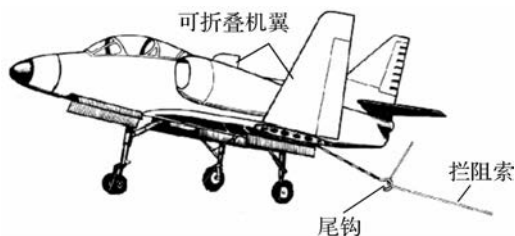
图 4-60 舰载机的结构特点
