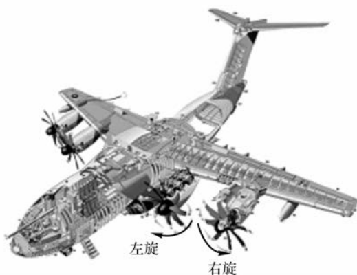
图 7-27 多发螺旋桨的旋向
