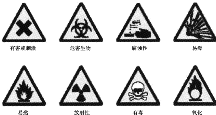
图 5-35 危险警告标示
