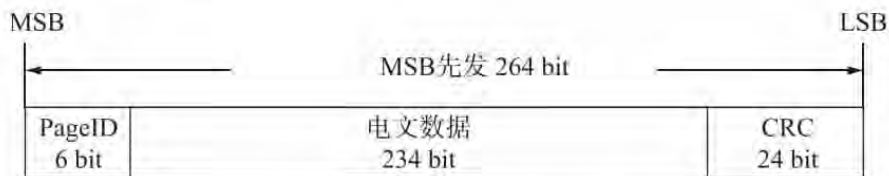
图 6.59 B-CNAV1 子帧 3 结构
