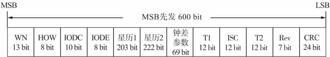
图 6.58 B-CNAV1 子帧 2 结构
