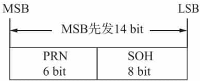
图 6.57 B-CNAV1 子帧 1 结构
