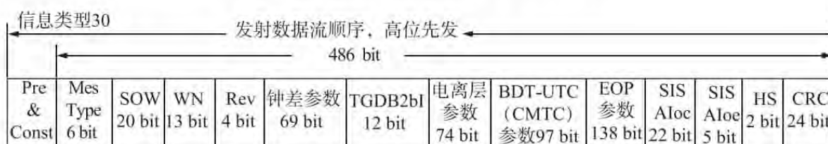
图 6.81 B-CNAV3 信息类型 30 编排格式
