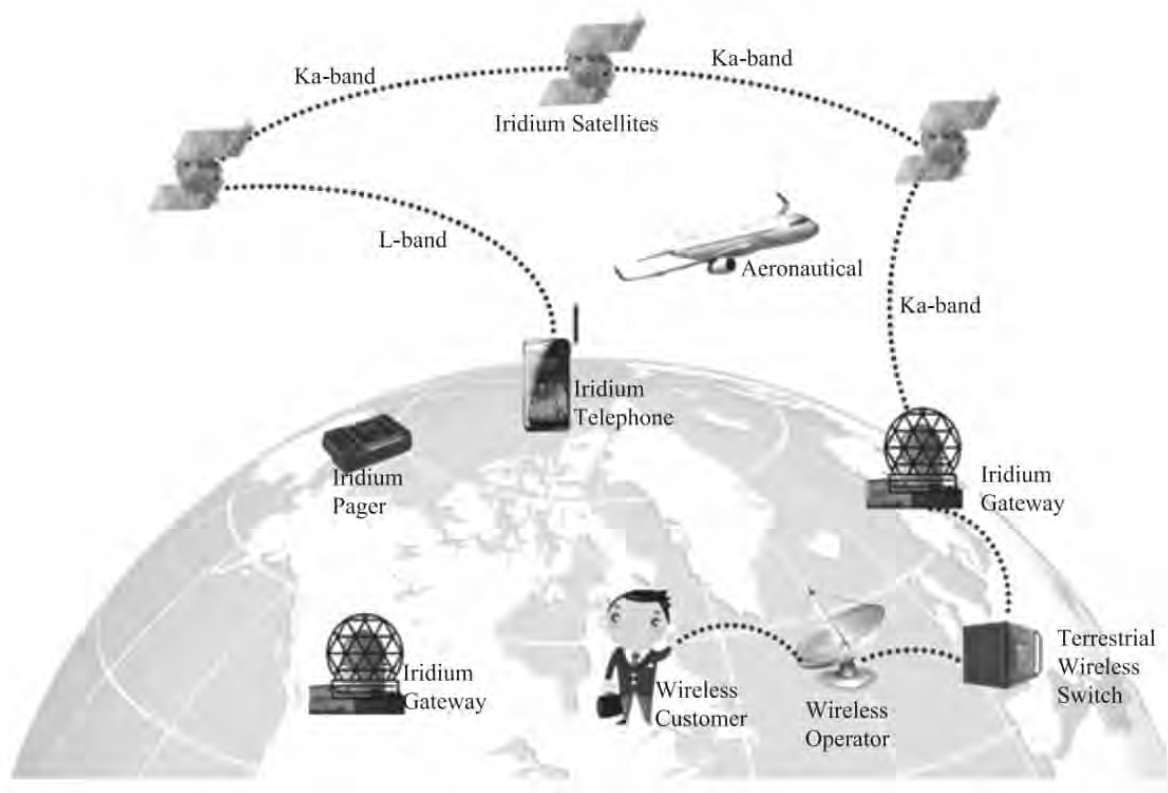
图 5.5 铱星系统结构简图
