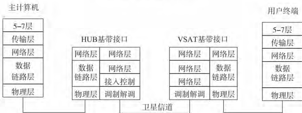
图 4.61 VSAT 的 OSI 结构
