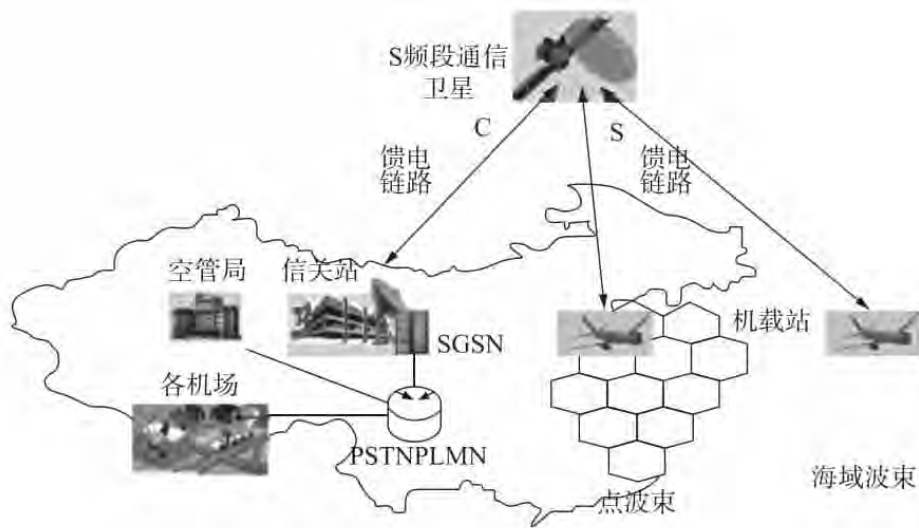
图 1.5 S 频段卫星移动通信在空管中应用的组网示意图
