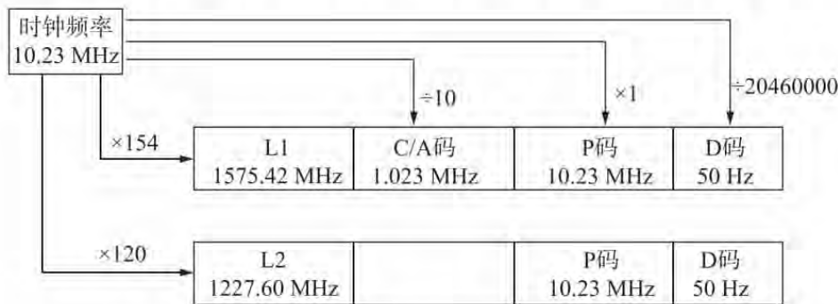
图 6.19 GPS 卫星信号之间的关系图
