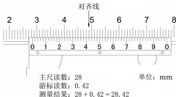
图 1.5 精度  $0.02\text{ mm}$  游标卡尺的读数方法
