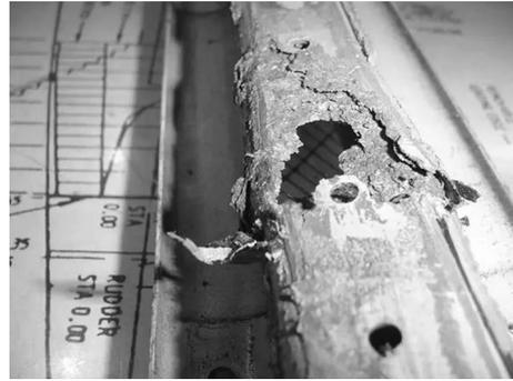
图 13.3 长桁的分层腐蚀
