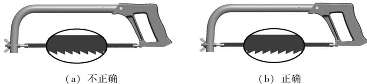
图 3.5 锯条的安装方向
