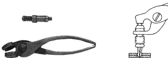
图 10.9 应用压钳操作的定位销
