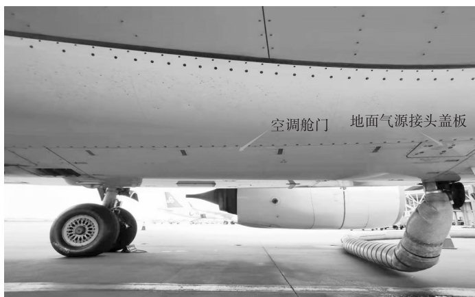
图 5.10 右侧空调舱门
