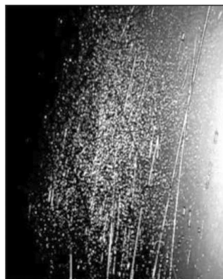
丙烯酸 (Acrylic) 风挡表面 划伤和龟裂局部放大图
