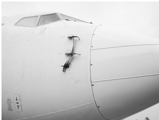
图 2.15 皮托管套安装完成
