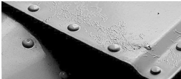
图 8.90 蒙皮表面的丝状腐蚀
