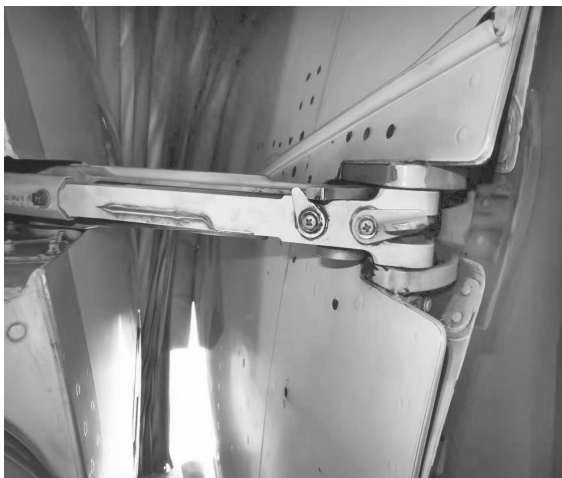
图 5.3 阵风锁（按压黄色手柄处解锁）
