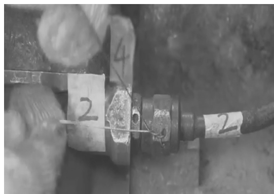
图 10.85 连接管路并打上保险
