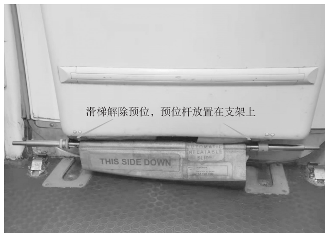
图 5.5 滑梯解除预位，预位杆放置在支架上
