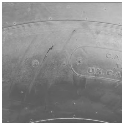
侧壁割伤、裂纹
