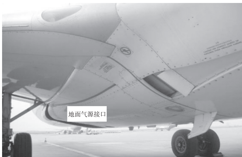
图 3.10 典型飞机地面气源接口位置
