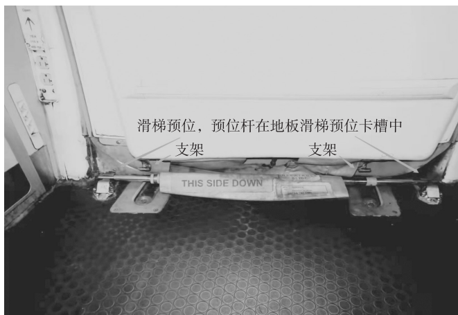
图 5.4 滑梯预位，预位杆在地板滑梯预位卡槽中
