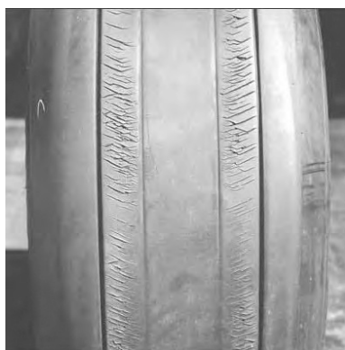
图 7.11 胎面鱼鳞纹 /Chevron cutting
