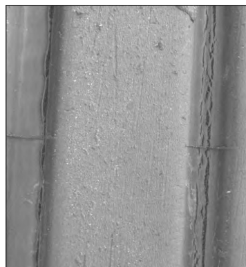
图 7.12 胎槽裂纹 /Groove cracking
