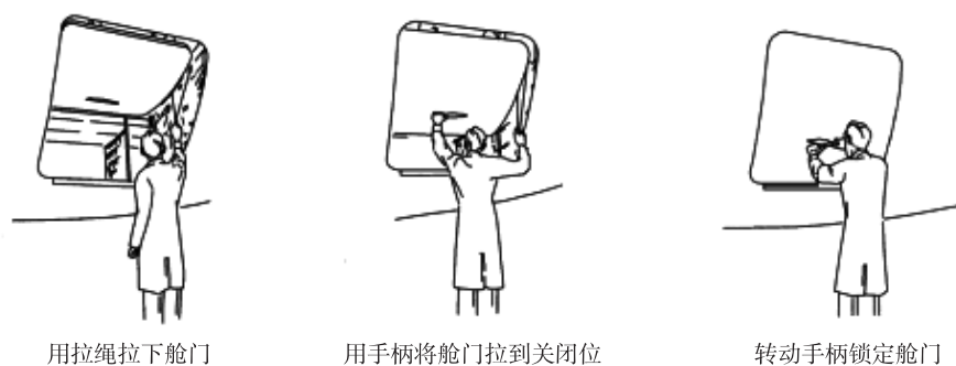
图 5.9 关闭货舱门
