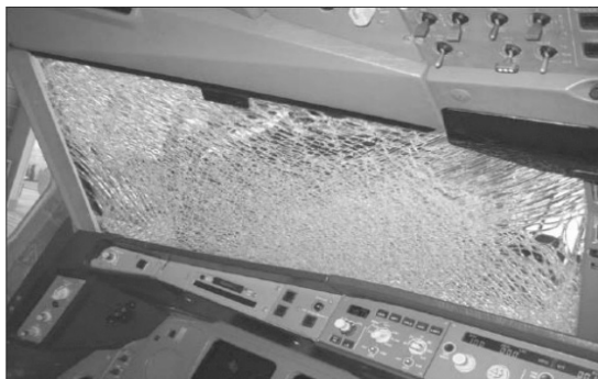
图 4.8 风挡玻璃内层裂纹
