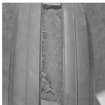
图 7.7 胎肋丢失 /Peeled rib
