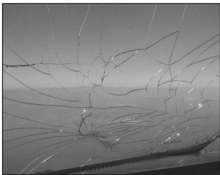
图 4.7 风挡玻璃外层裂纹
