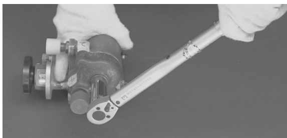
图 10.82 使用力矩扳手打力矩
