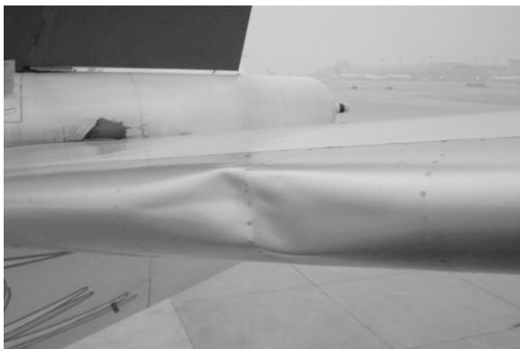
图 8.91 水平安定面前缘的折痕
