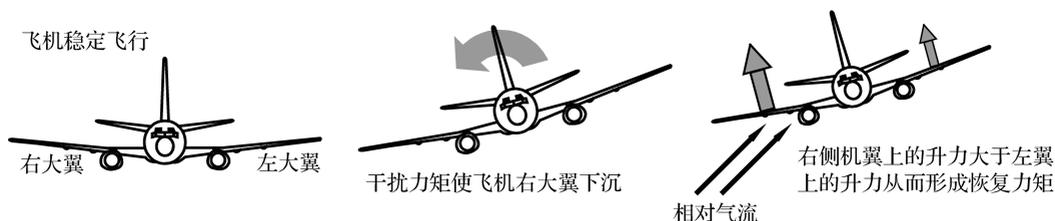
图 3.11 飞机的侧向稳定性
