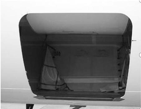
图 4.7 向内开启的下货舱门
