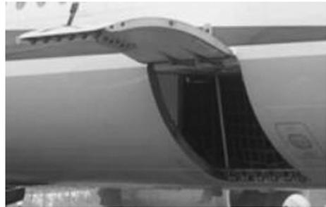
图 4.8 向外开启的下货舱门
