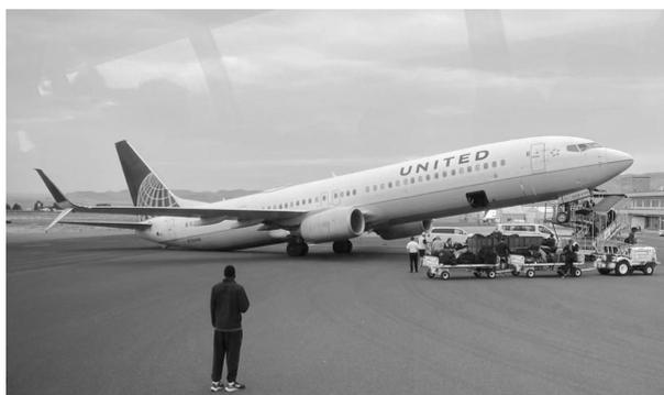
图 2.8 飞机失衡坐尾事件
