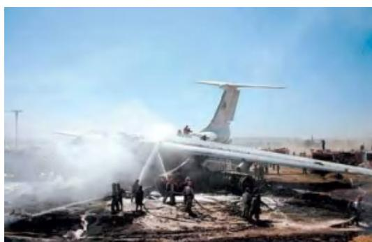
**事故原因：**(1) 无视航空安全、严重超载。经事后调查发现，4K-AZ27货机申报载货重量44吨，实际载重超过70吨，远超伊尔-76TD飞机的额定载重（40吨），甚至超过飞机极限载重（50吨）的50%，属于无视航空运输安全规定的严重超载行为。(2) 发动机老旧、性能严重衰退。飞机的4台D-30KP型涡轮风扇发动机，有2台已经过了报废年限，另外2台也已经接近报废年限，导致飞机的动力大打折扣，再加上起飞机场海拔较高、气温较高，发动机的性能进一步受影响。(3) 恶劣天气影响。当时乌鲁木齐有7级大风、强烈的沙尘暴天气和风切变现象，也是导致飞机坠毁的客观原因
