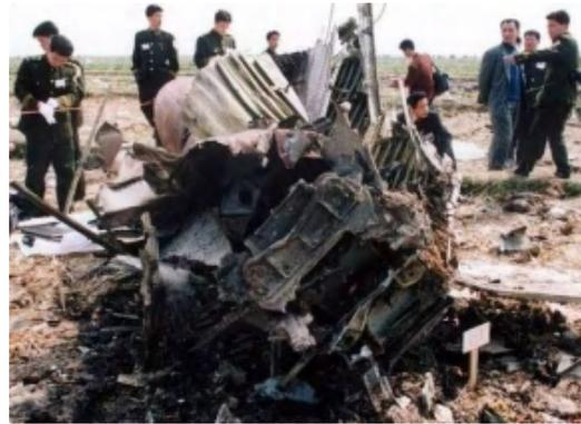
**事故原因：**这是一起由于严重的人为差错所导致的空难。飞机在空中飞行时，受到外界干扰会产生轴向角加速度，使飞机偏离预定状态，飞机上的阻尼器会产生阻止飞机偏离预定状态的阻尼作用，使飞机恢复到正常状态。由于一系列的人为差错，这架飞机自动驾驶系统/阻尼器上的两个插头相互插错，即控制副翼（横滚）的插头安插在控制方向舵（航向）的插座中，而控制方向舵的插头安插在控制副翼的插座中。飞机起飞后不久在空中出现了发散性的飘摆，在两个插头相互插错的情况下，阻尼器不仅未能产生稳定飞机姿态的作用，而且使飞机的飘摆愈演愈烈，导致飞机的动稳定性变差，机组无法正常控制飞机，随后飞机出现失速，在急速下坠过程中产生了严重过载，导致飞机在空中解体，造成了此次空难。
