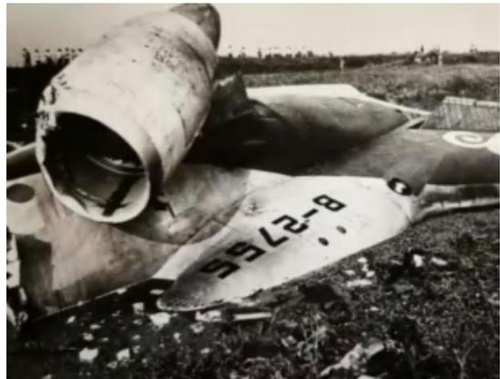
**事故原因：**机组人员未严格执行操作程序，起飞前未将全动式水平尾翼调整到与飞机重心相适应的角度，致使该飞机起飞始终未能有效离地而冲出跑道。雅克-42D型飞机按规定程序，机组需要在飞机滑出前将水平尾翼调节到起飞所需角度，并经地面机务人员确认后，方可起飞。而在这次飞行任务中，机组既没有正确调节水平尾翼角度，又没有请机务人员观察校对，飞机上的水平尾翼警告系统发出警告后，还盲目按压解除按钮，导致警告系统失效，未能及时发现水平尾翼存在的隐患，从而导致了此次惨重的事故。
