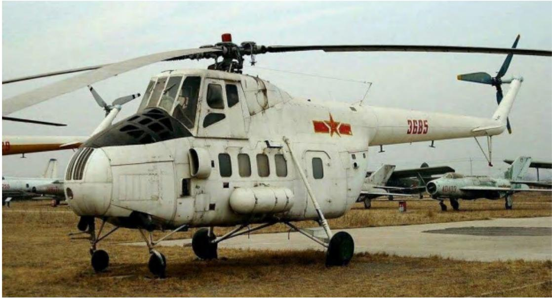
直-6 是在直-5 的基础上改型设计、自行研制的多用途直升机。相较于直-5，直-6 配备了新型涡轴-5 发动机，在发动机布局、旋翼桨叶和机身上也作了改进。从 1960 年代至 1970 年代，直-6 总计生产制造了 15 架，但由于发动机技术的落后以及单发布局的安全性和可靠性差，直-6 项目以失败告终。
