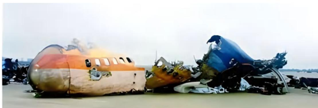
事故原因：这是一起主要由人为差错所导致的空难，大雨下能见度不佳为客观原因。(1) 台风“象神”将至导致机场疾风暴雨、能见度低。机组不希望航班延误，急于起飞。(2) 机场的指示设施不到位，导致飞机误闯正在施工维修而暂停开放的跑道(05R)。(3) 机组与塔台沟通不良，交通管制员的操作不符合程序。(4) 机组人员疏忽，未能察觉飞机进入错误跑道(正确跑道为05L)，且忽略了飞机相关仪表的提示。
