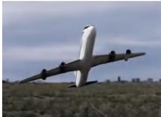
**事故原因：**装载人员未按规定装载，造成飞机重心超限，且飞机纵向配平不正确酿成了此次事故。(1) 没有正确核算飞机的载重量，由于没有把托盘、货网等重量计入飞机载重，导致实际载重比记录载重多出约 2.3 吨。(2) 随意调整货物位置，未按规定摆放、固定货物，导致重心后移超出了合理的重心范围。(3) 没有将实际装载情况告知机组，导致飞机起飞配平错误。
